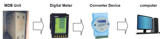
รูปที่ 1 การเชื่อมต่อดิจิทัลมิเตอร์
