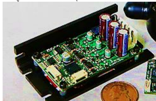
รูปที่ 7 โครงสร้างและชุดขับเคลื่อนคอมเพรสเซอร์ BLDC
